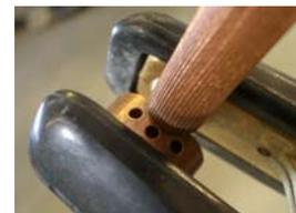
Adatti ad eseguire lavori di scriccatura con elettrodi al carbone (16 mm max), sono in grado di erogare corrente fino a 1800 A. Potenza e flessibilità del nuovo modello TS 1081/D (grazie alla possibilità di utilizzo dei due generatori anche separatamente), oltre all'ottimo rapporto qualità-prezzo, fanno del sistema ICEB un punto di riferimento in Italia per tutti i lavori di scriccatura.
