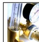
**Riduttore di pressione per la saldatura TIG**
