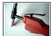
**TORCIA TIG mod. T150:** rispetto alle torce TIG con rubinetto, questa torcia apre e chiude il gas mediante pulsante, molto più comodo e utile per evitare i ritorni di fiamma e gli sprechi di gas. COD. TOR2CEBOA950
